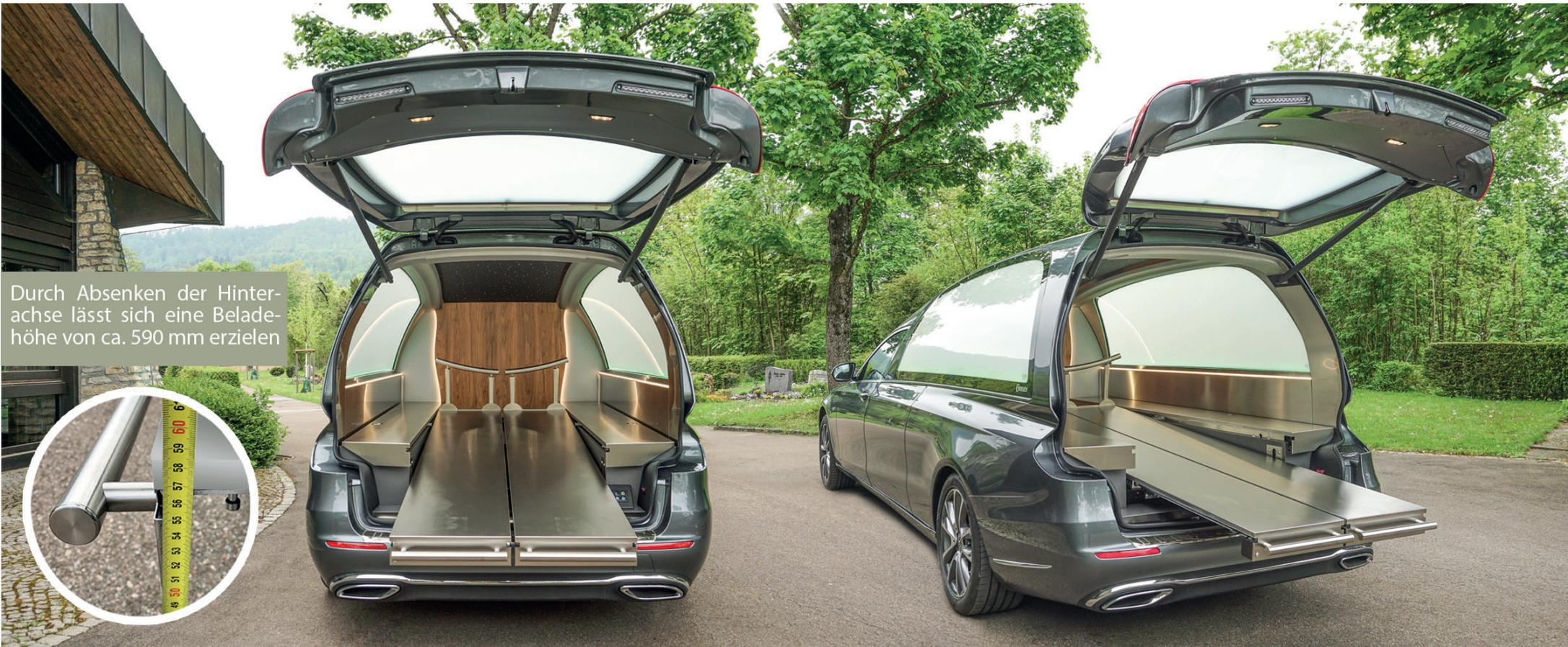
Durch Absenken der Hinterachse lässt sich eine Beladehöhe von ca. 590 mm erzielen
