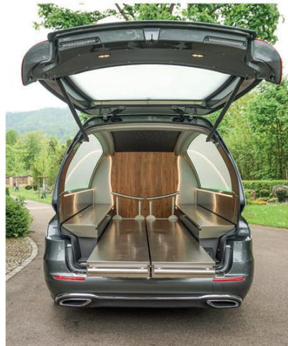
Mit unserem Beladeassistenten öffnet sich mit Betätigung des Fahrzeugschlüssels die Heckklappe und die Beleuchtung im Sargraum schaltet sich ein. Dabei fährt der Sargladeboden vollautomatisch aus.
