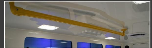
**Eine robuste Haltestange im Bereich der Decke gibt sicheren Halt für die Betreuer.**
