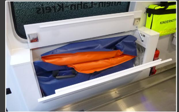
**Schrank zur Aufnahme einer Vakuummatratze an der linken Seitenwand.**
