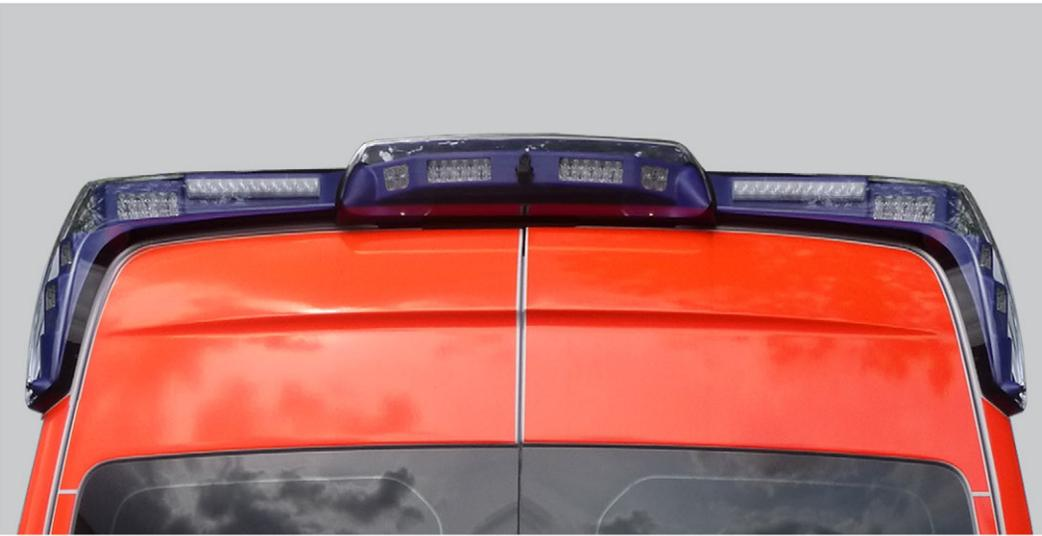
Unsere integrierte Blaulichtanlage bietet eine Vielzahl an Möglichkeiten. Die Form der Warnanlage ist der Fahrzeugkontur angepasst. Das minimiert den Windwiderstand und somit auch die Geräusentwicklung und den Kraftstoffverbrauch.
