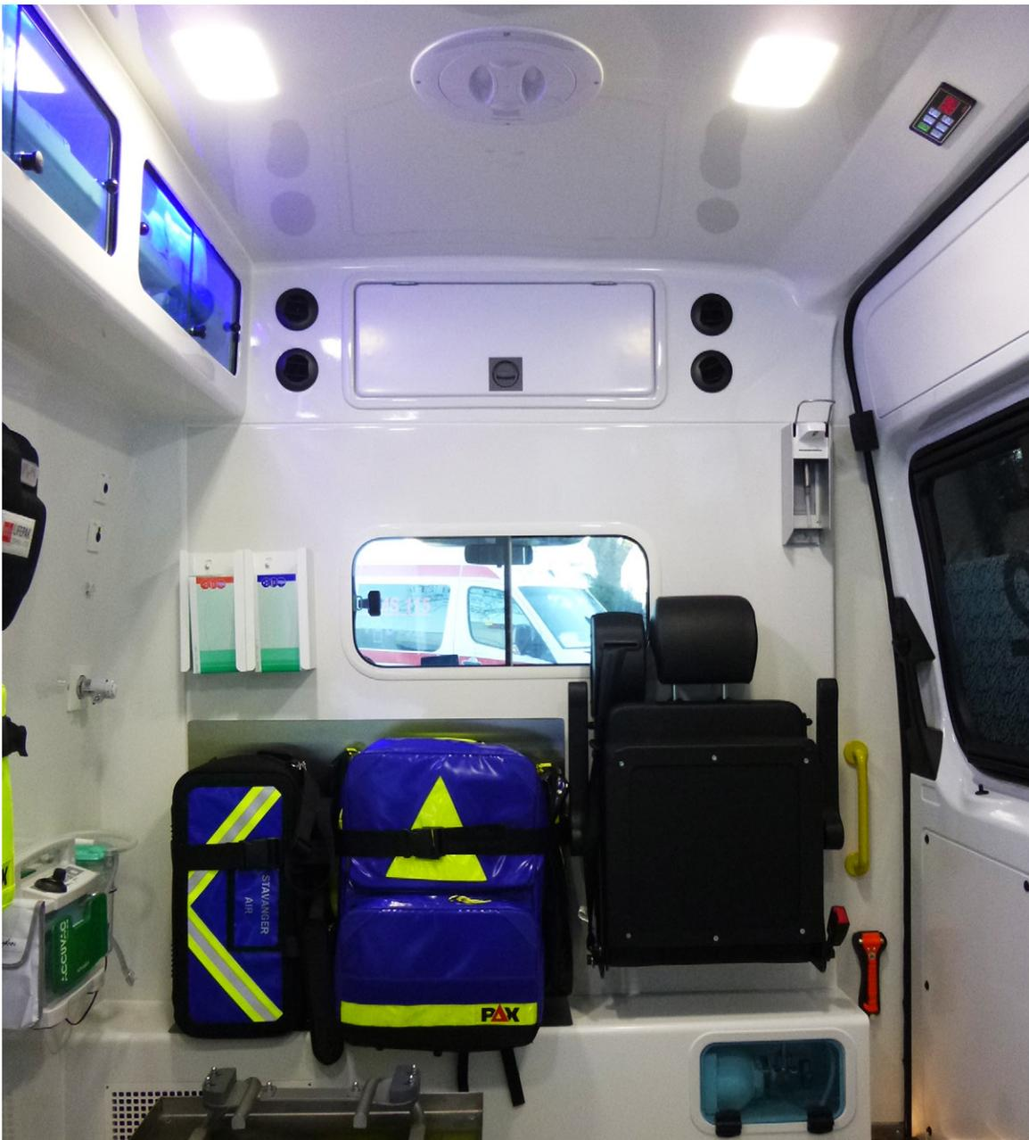
An der Trennwand befindet sich ein ergonomisch geformter Betreuersitz, mit klappbarer Sitzfläche, Rückenlehne, Kopfstütze und 3-Punkt Automatikgurt. Eine Halterung für einen Notfallrucksack, bzw. für einen Koffer. Die Innenbeleuchtung im Patientenraum ist auf Basis hochwertiger LED-Leuchten. Diese sind bei Bedarf dimmbar und auf Traumabeleuchtung umschaltbar.
