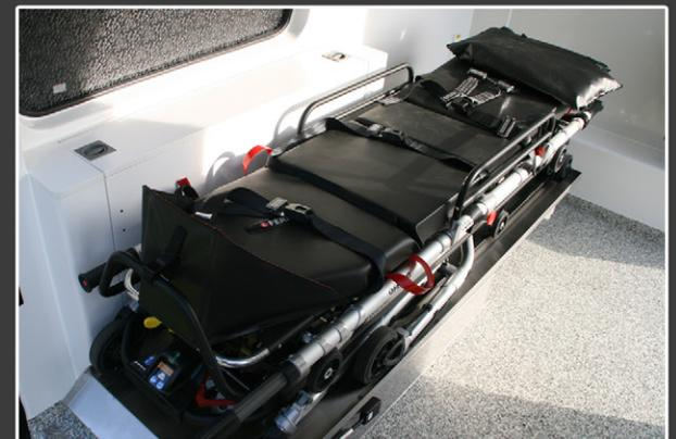
**Das Be- und Entladen der Trage erfolgt über die bewährte MIESEN Schiebepöhlle. Diese ist benutzerfreundlich und bietet allen gängigen Tragervarianten sicheren Halt.**
